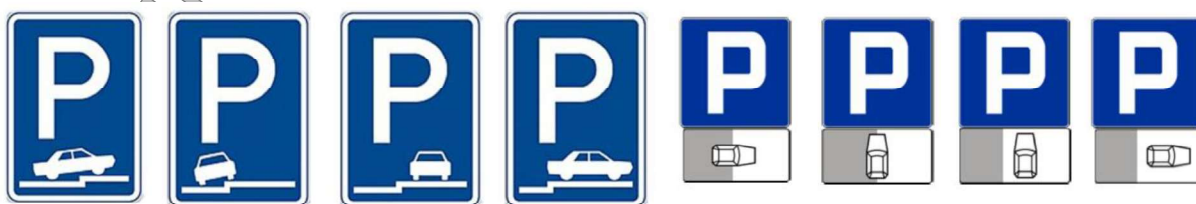
Rys. 8.7.2.20 Czeskie znaki z serii nr IP-11 oraz polskie odpowiedniki znak D-18 z tabliczkami z serii T-30
