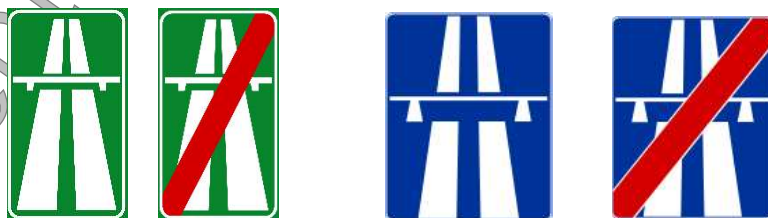
Rys. 8.8.2.15 Włoski znak autostrada II 345 art. 135 oraz II 346 art. 135 oraz polskie znaki D-9 oraz D-10
