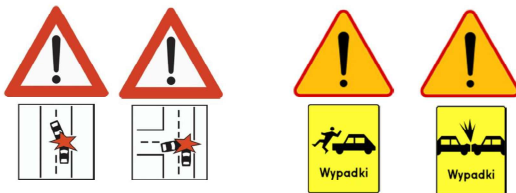
Rys. 8.5.2.23 Przykładowy sposób tworzenia tabliczek uzupełniających pod znakami ostrzegawczymi w Norwegii i w Polsce w miejscach szczególnie narażonych na powstawanie wypadków drogowych.
