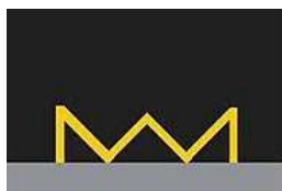
Rys. 8.8.2.6 Czeski znak poziomy V-11a „przystanek autobusowy” (z adnotacją „BUS”) oraz V-12a „przystanek autobusowy”
