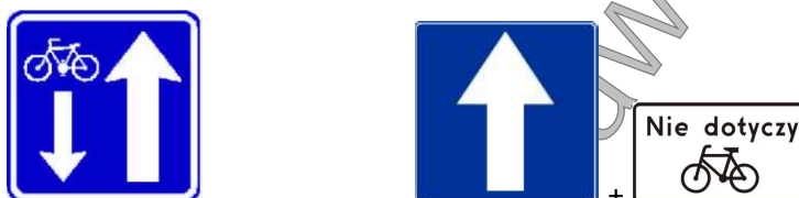
Rys. 8.7.2.18 Czeski znak IP-4c oraz polski odpowiednik znak D-3 z T-22
