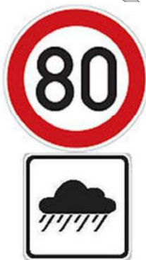
Rys. 8.7.2.29 Przykładowy czeski znak B-20a w połączeniu z tabliczką uzupełniającą E-6
