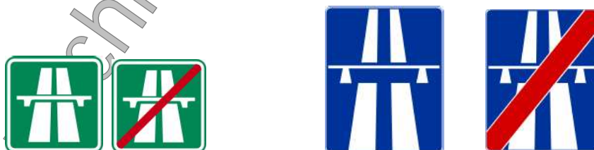
Rys. 8.7.2.16 Czeski znak autostrada IZ-1a oraz IZ-1b oraz polskie znaki D-9 oraz D-10
