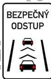
Rys. 8.8.3.2 Czeski znak poziomy nr V-16 „bezpieczny odstęp” wraz z czeskim znakiem pionowym IP-32 „bezpieczna odległość”
