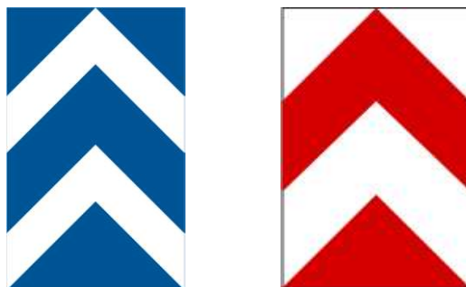
Rys. 8.6.3.2 Szwedzka tablica oznakowania przeszkody nr X-4 oraz polska tablica rozdzielająca U-4b
