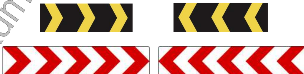
Rys. 8.5.3.1 Norwесkie urządzenia bezpieczeństwa ruchu drogowego nr 902H oraz 902V oraz polskie tablice prowadzące U-3c oraz U-3d
