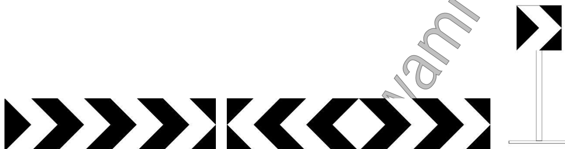
Rys. 8.7.3.1 Przykładowe tablice odpowiadające polskim tablicom U-3 stosowane we Włoszech
