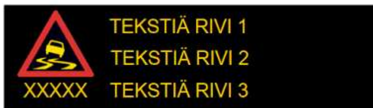
Rys. 8.9.2.1. Przykładowa tablica o zmiennej treści w Norwegii (znak i trzy wiersze)
