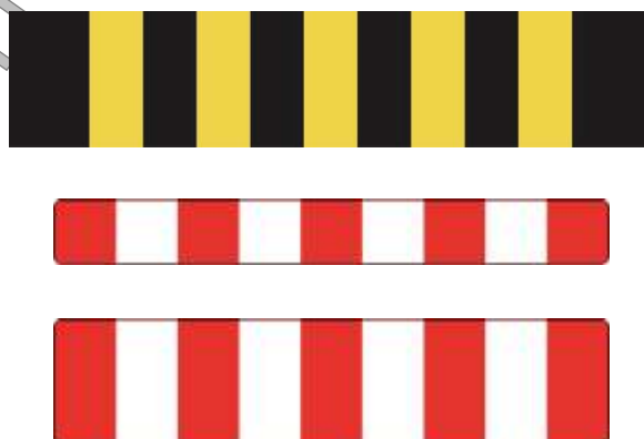
Rys. 8.5.3.4 Norweskie rozwiązania w zakresie zapór drogowych nr 908 oraz polskie zapory drogowe U-20a oraz U-20b
