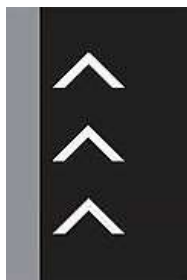
Rys. 8.8.3.2 Czeski znak poziomy nr V-16 „bezpieczny odstęp” wraz z czeskim znakiem pionowym IP-32 „bezpieczna odległość”
