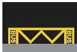
Rys. 8.8.2.6 Czeski znak poziomy V-11a „przystanek autobusowy” (z adnotacją „BUS”) oraz V-12a „przystanek autobusowy”
